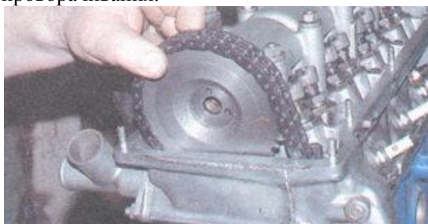
42. Снимите звездочку с цепью с распредвала, снимите цепь со звездочки и опустите ее вниз.
