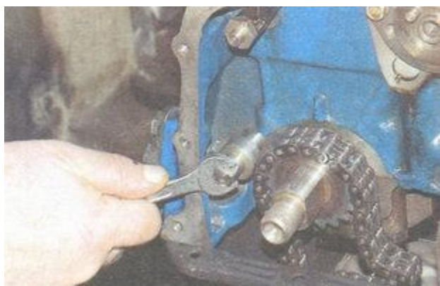
44. Выверните ограничительный болт и снимите цепь привода распредвала
