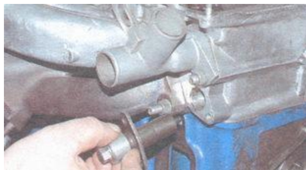
. Отверните два болта крепления натяжителя цепи и снимите его.
