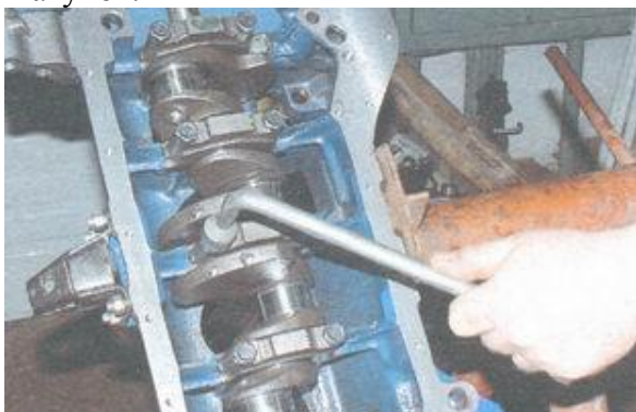
68. Выверните два болта крепления любой крышки коренного подшипника
