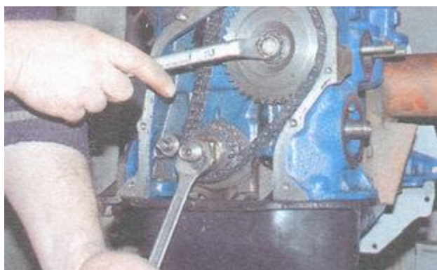
40. Ослабьте затяжку болта крепления звездочки валика привода вспомогательных агрегатов, удерживая коленвал от проворачивания.
