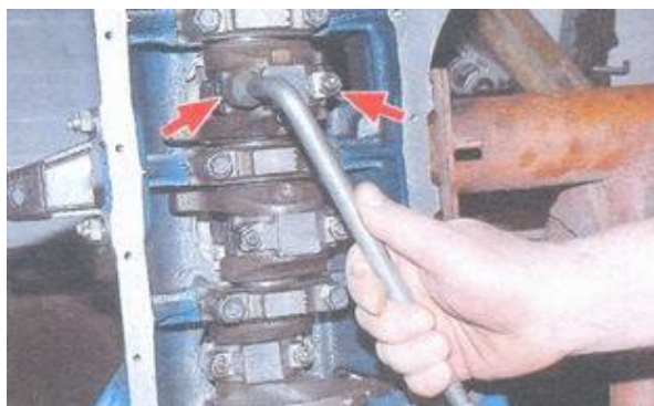
63. Отверните две гайки крепления крышки шатуна любого цилиндра.
