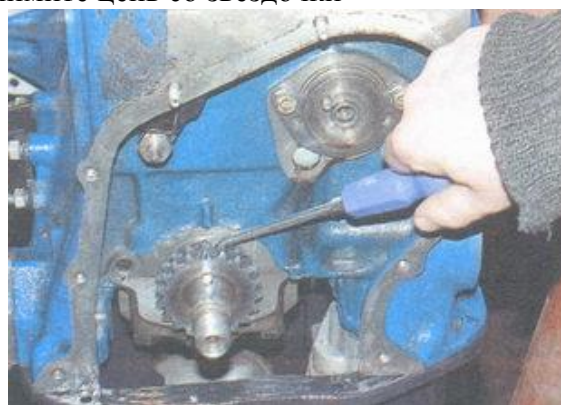
45. Сдвиньте звездочку коленвала и снимите ее.
