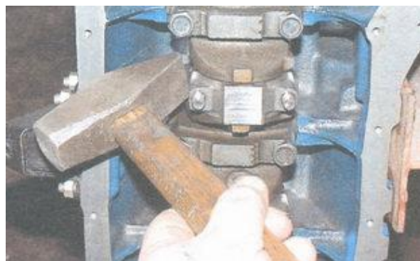
64. Сдвиньте крышку шатуна с посадочного места легкими ударами молотка и снимите крышку с вкладышем.
