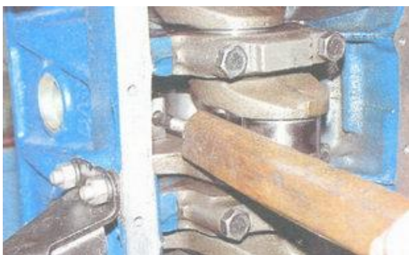
65. Нажмите деревянным брусом (ручкой молотка) на болты шатуна и...
