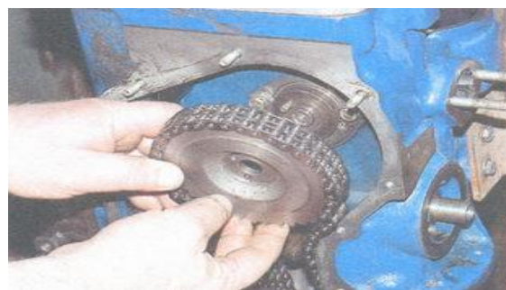
43. Выверните болт крепления звездочки валика привода вспомогательных агрегатов, снимите звездочку с цепью с валика и снимите цепь со звездочки
