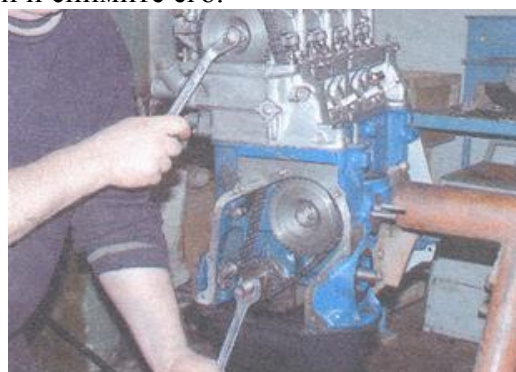
41. Выверните болт крепления звездочки распредвала, удерживая коленвал от проворачивания.
