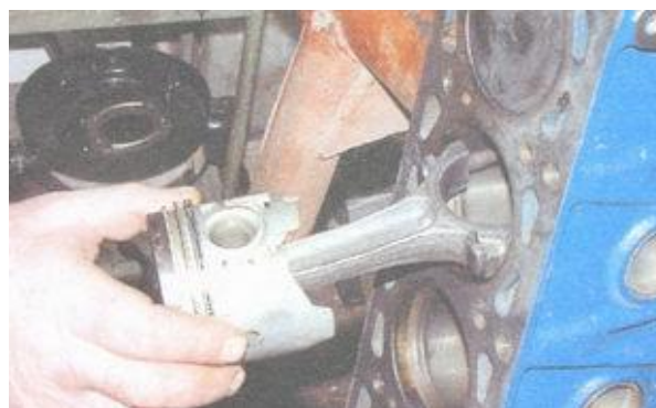
66. Выньте поршень с шатуном из цилиндра в сторону верхней плоскости блока цилиндров.
